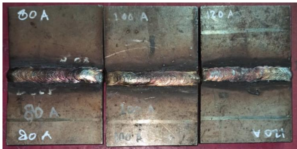
Gambar 2 Hasil pengelasan polaritas DCEP
