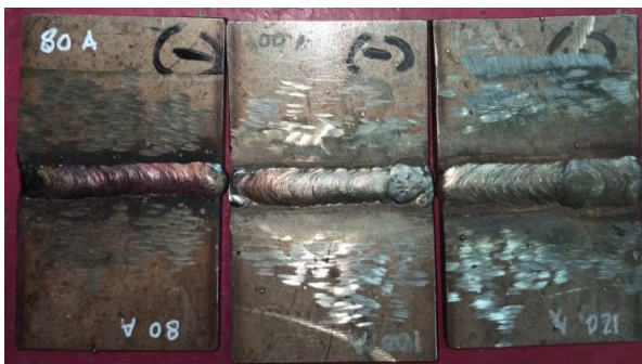
Gambar 3 Hasil pengelasan polaritas DCEN
