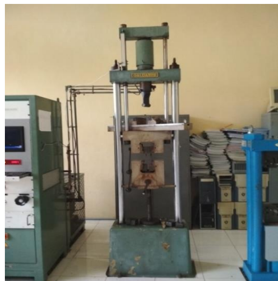
Gambar 3 Mesin Uji Tarik (Sumber ; Lab Uji Bahan Politeknik negeri Ilokseumawe )
