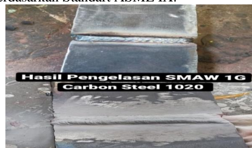
Gambar 5 Hasil Pengelasan SMAW 1G C-1020
