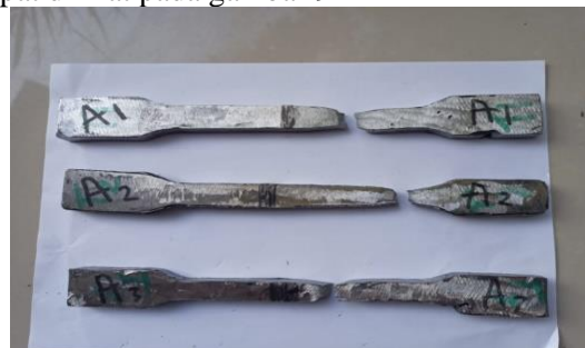
Gambar 9 Patahan Spesimen A1,A2, dan A3 setelah pengujian tarik
