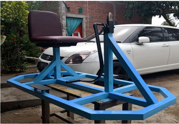
Gambar 6 Alat Bantu Pengupas Kulit Kelapa
