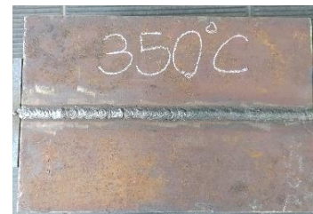
Gambar 3.7 Hasil lasan temperatur elektroda dengan suhu 350^{\circ}\text{C}
