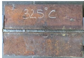
Gambar 3.4 Hasil lasan temperatur elektroda dengan suhu 325^{\circ}\text{C}
