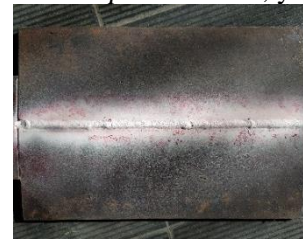
Gambar 3.10 Spesimen hasil penetran dengan suhu pemanasan 300° C
