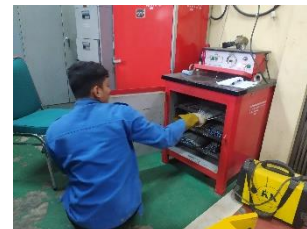
Gambar 2.2 Proses pemanasan elektroda ke dalam baking oven electrode
