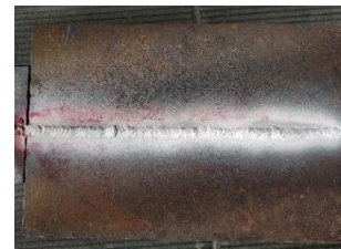
Gambar 3.11 Spesimen hasil penetran dengan suhu pemanasan 325° C
