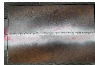
Gambar 3.12 Spesimen hasil penetran dengan suhu pemanasan 350° C
