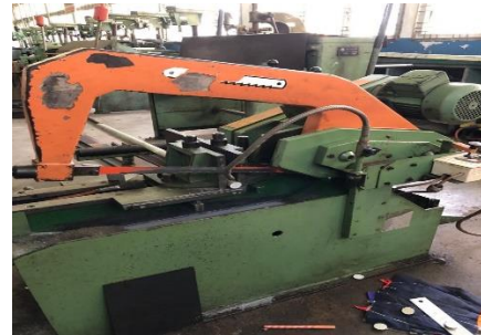
Gambar 2.1 Proses Pemotongan Spesimen Dengan Mesin Gergaji Potong.
