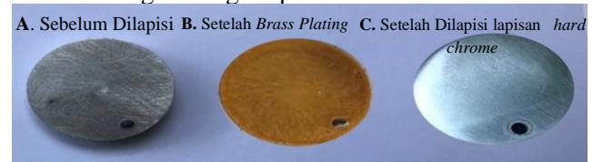
Gambar 3.3 Spesimen material sebelum di lapisi, setelah Brass Plating dan setelah dilapisi hard chrome
