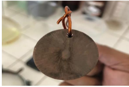
Gambar 3.1 Permukaan Aluminium Setelah Proses Zinkcate .
