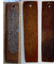
Gambar 4. 2 spesimen baja karbon perendaman ke 30, 60 dan 90 hari
