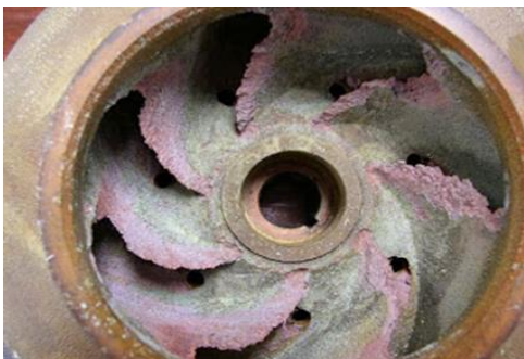
Gambar 2. 3 korosi erosi pada impeler pompa (Sumber : Utomo, 2019 )
