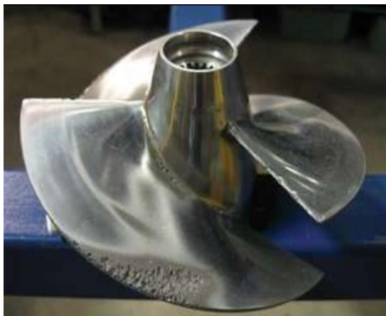
Gambar 2.8 Korosi Kapitasi pada baling baling perahu
