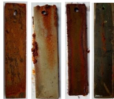
Gambar 4. 4 Gambar Spesimen yang mengalami korosi paling parah (a.Baja karbon b.Stainless steel c.Baja karbon yang dilapisi dengan cat d.baja karbon yang dilapisi dengan resin poliester).
