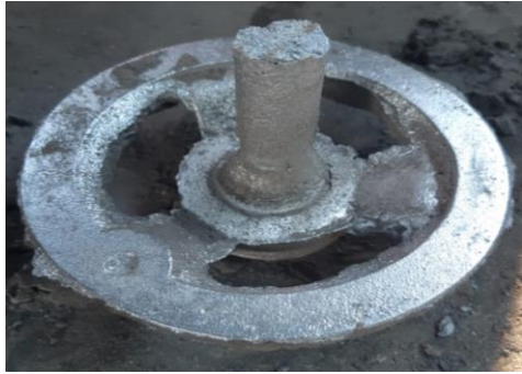
Gambar 6 Hasil pengecoran handwheel sebelum finishing
