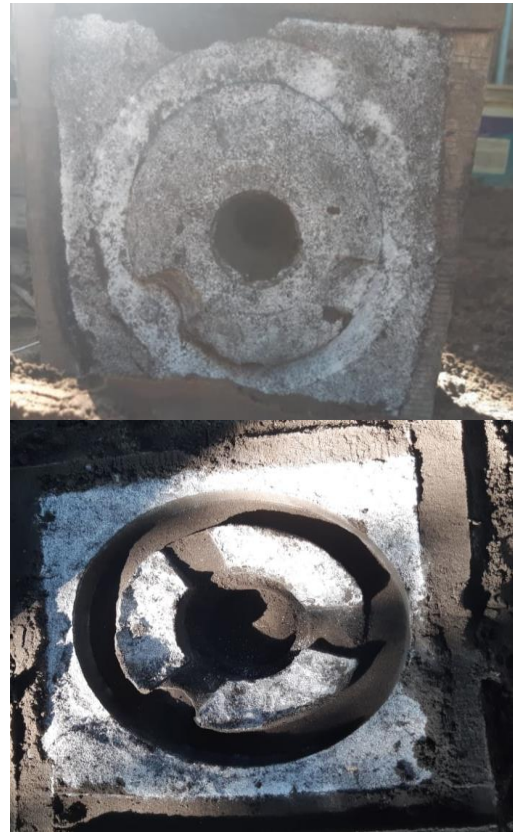
Gambar 5 Hasil cetakan handwheel atas dan bawah
