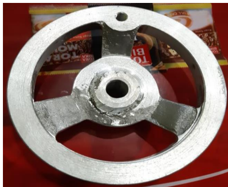
Gambar 7 Hasil pengecoran handwheel setelah finishing
