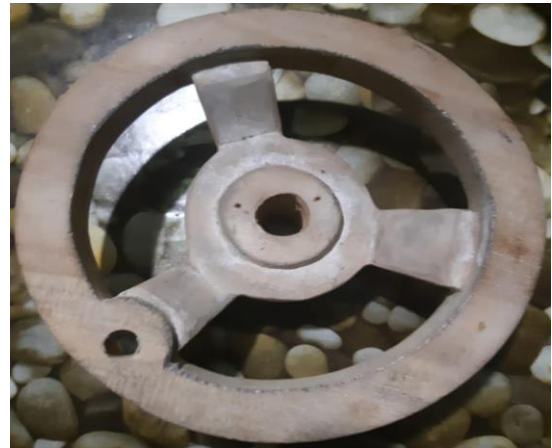
Gambar 9 Pola kayu handwheel mesin bubut pindad model PL-1000 G
