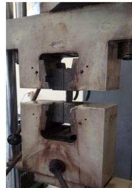
Gambar 3.1 Mesin Uji Tarik Galdabini 2007,Italy
