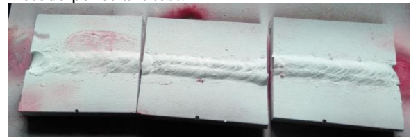
Gambar 3.2 Hasil Pengujian Penetrant pada Pengelasan SMAW dengan menggunakan Elektroda E6013, E7016 dan E7018
