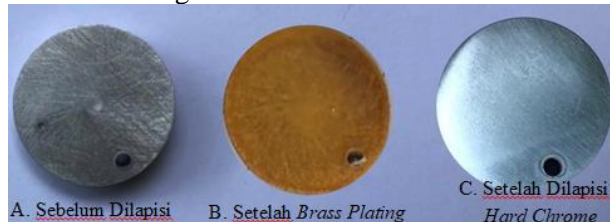
Gambar 3.1 Permukaan Spesimen Saat Proses Pelapisan Hard Chrome
