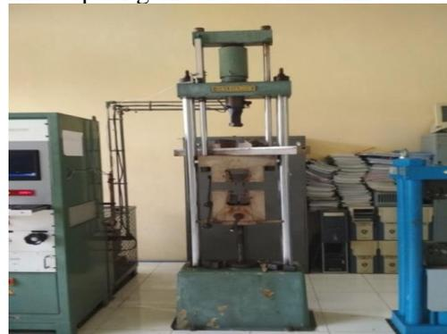
Gambar 3.4 Mesin uji tarik
