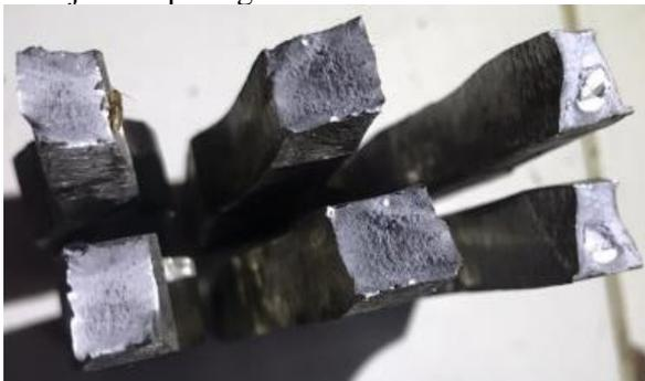
(a) Bentuk Hasil Patahan Pengujian Tarik Variasi Arus 100 A
