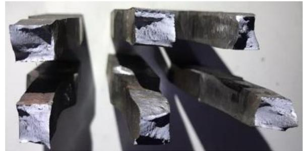
(c) Bentuk Hasil Patahan Pengujian Tarik Variasi Arus 150 A
