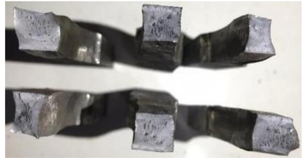
(b) Bentuk Hasil Patahan Pengujian Tarik Variasi Arus 120 A
