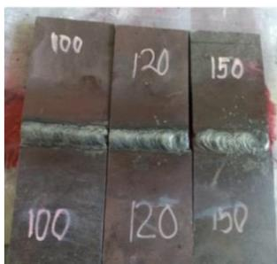
Gambar 4.1 Hasil pengelasan arus 100 A, 120 A, dan 150 A
