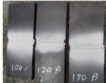
Gambar 4.2 Hasil pengujian penetrant test
