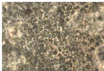
Gambar 4.4 Struktur mikro baja ST 60 kondisi awal
