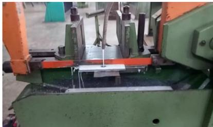
Gambar 3.6 Pemotongan spesimen uji ST 60
