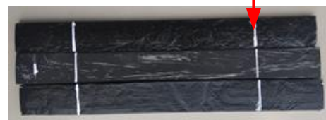
Gambar 3.2 Spesimen Uji Tarik Standar ASTM3090
