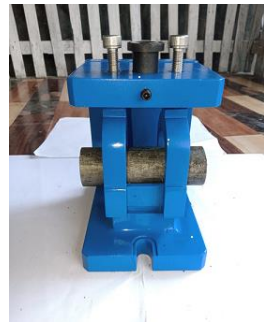
Gambar 4. 1 Drilling Jig (Sumber : Hasil Perencanaan)
