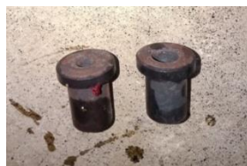
Gambar 4. 2 Bushing Setelah Dilakukan Perlakuan Panas (Sumber : Hasil Pengujian)
