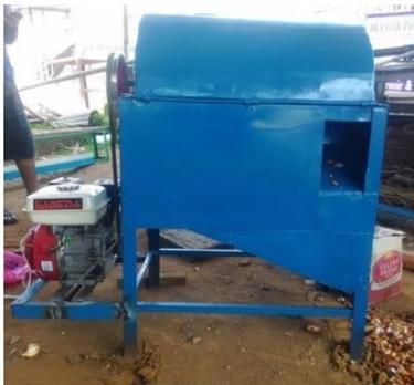
Gambar: 2. Mesin pemecah buah coklat dengan daya 5,5 HP
