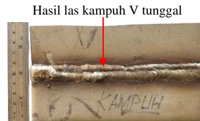
Gambar 4 Hasil pengelasan SMAW bahan AISI 304 kampuh V sudut 70^\circ
