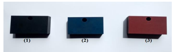
Gambar 4.2 Spesimen Hasil Anodisasi dengan Variasi Suhu (1) 5\text{ }^{\circ}\text{C} , (2) 10\text{ }^{\circ}\text{C} , dan (3) 15\text{ }^{\circ}\text{C} , Konsentrasi Larutan Asam Sulfat 12\% dan Asam Oksalat 1\% .
