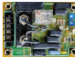
Gbr. 9 Modul Regulator Tegangan Eksitasi Medan Rotor Generator
