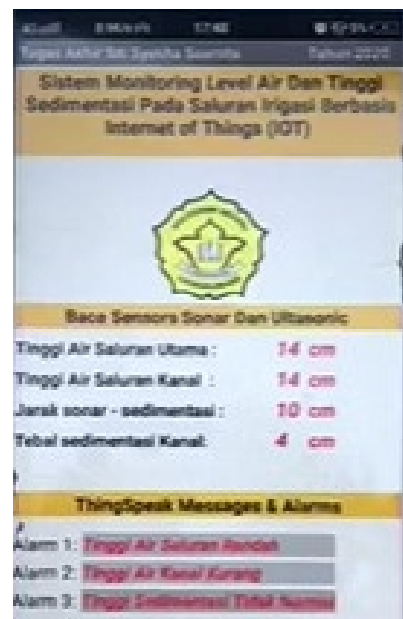
Gbr. 11 Tampilan monitoring tinggi sedimentasi dan level permukaan dari perangkat Android
