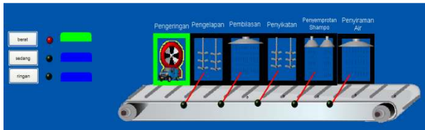
Gbr. 23 Blok 6 Pengeringan Output %Q0.6
