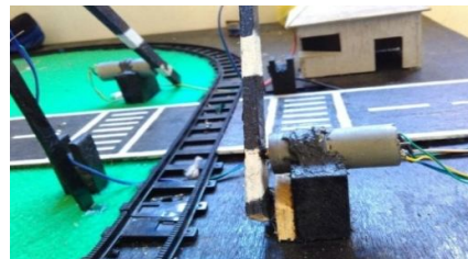
Gambar 3.3 Motor DC Penggerak Palang Pintu
