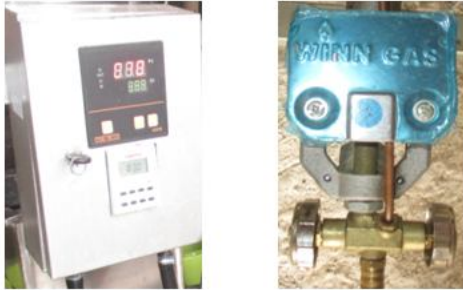
Gambar 3.6 Sistem Kendali pada alat penyulingan
