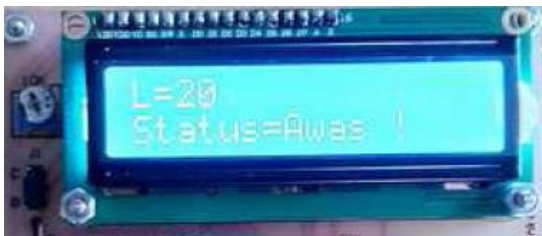
Gambar 12 Hasil pengujian sistem peringatan dini banjir yang diperlihatkan pada tampilan LCD
