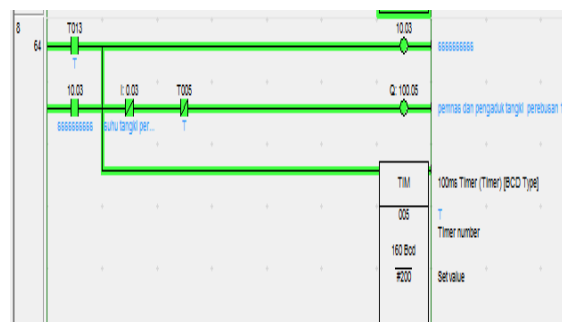
Gambar 10 Simulasi Pemanas Dan Pengaduk Pada Tangki Perebusan.
