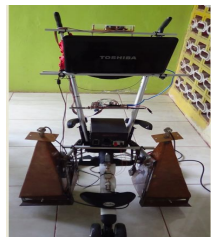
Gambar 11. Prototype radar pendeteksi kabel bawah tanah
