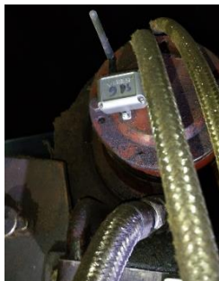
Gambar 1. Sensor yang terpasang pada bearing mesin kertas di Pabrik PT. XYZ
