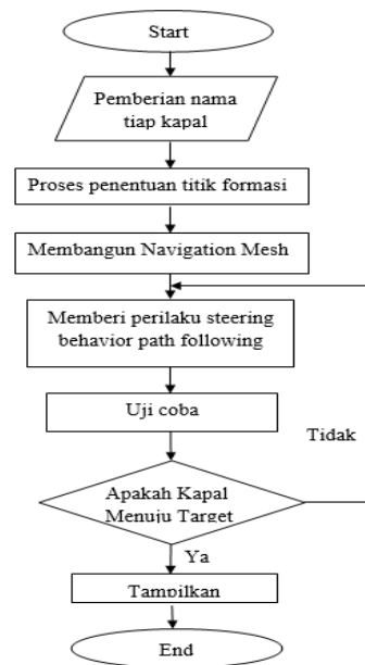
Gambar 3. Flowchart Diagram kapal laut menuju titik target
