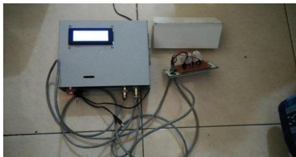
Gambar 2. Perangkat pengukuran suhu dan kelembapan dengan TMR
