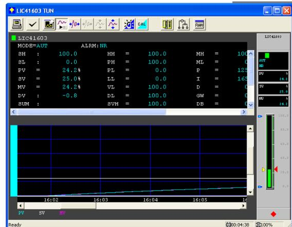
Gambar 3.8 Respon LIC 41603 menggunakan parameter pengendali PID dengan metode *Ziegler-Nichols*
