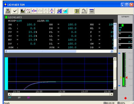
Gambar 3.7 Respon LIC 41603 menggunakan parameter pengendali PI dengan metode *Tyreus-Luyben*
