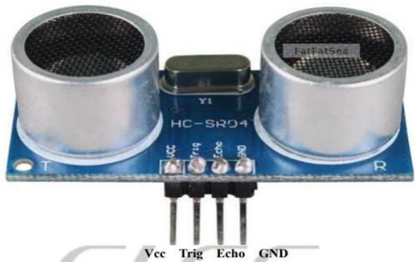
Gambar 3. Bentuk sensor deteksi objek yang digunakan [8],[9] Sensor ini memiliki 4 terminal yang masing - masing berfungsi sebagai seperti Tabel. I
