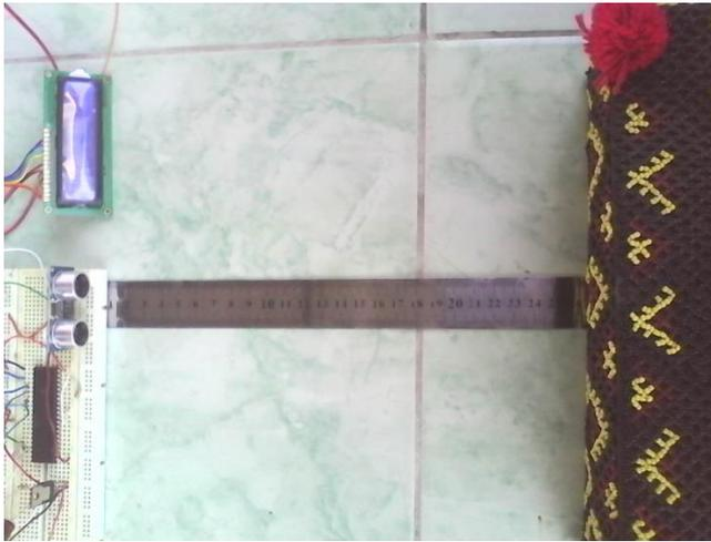
Gambar 11. Perbandingan pengukuran jarak menggunakan sensor HC-SR04 dengan mistar
