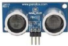
Gambar 2 Bentuk sensor ultrasonic (Sumber : jurnal.upi.edu/electrans )
