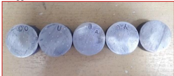
Gambar 6. Spesimen Hasil Pengujian Kekerasan Rockwell
