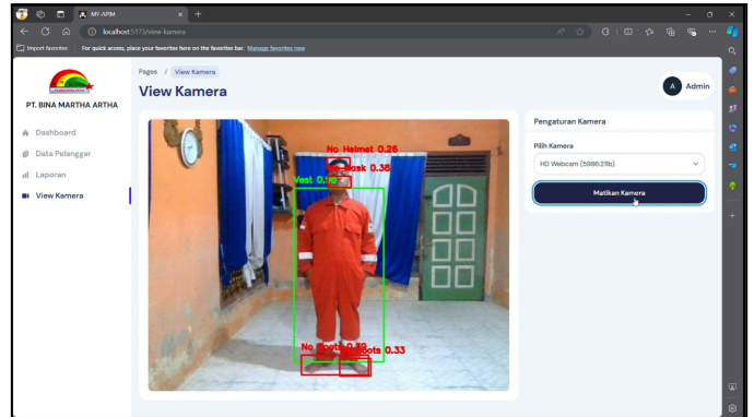
Gambar 17. Deteksi APD Tidak Lengkap
