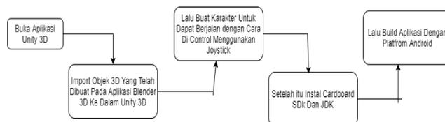
Gambar 2. Blok Diagram Pembuatan Aplikasi di Unity
