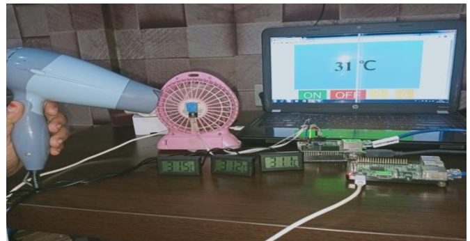
Gambar 11 Perbandingan Modul dan Thermometer Menggunakan Hairdryer
