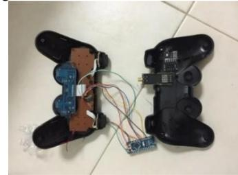
Gambar 10. Tampak Joyistik kendali jarak jauh robot mobil
