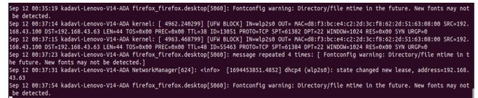
Gambar 7. Serangan TCP flood yang masuk pada log system
