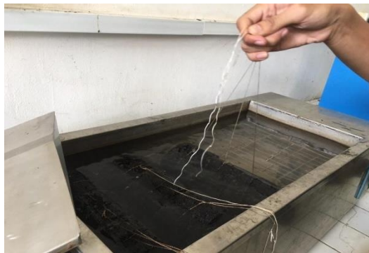
Gambar 4.12 Perendaman Benda Uji Pada Waterbath
