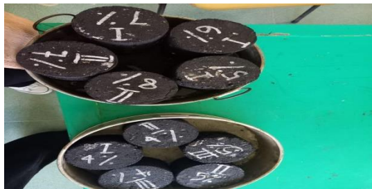
Gambar 4.8 Memberi Kode Pengenal Pada Benda Uji
