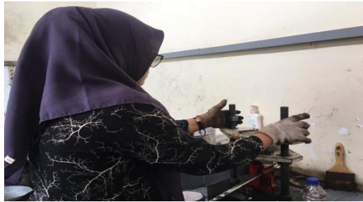
Gambar 4.7 Pengeluaran benda uji dengan extruder
