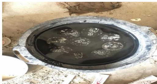
Gambar 4.10 Perendaman Benda Uji
