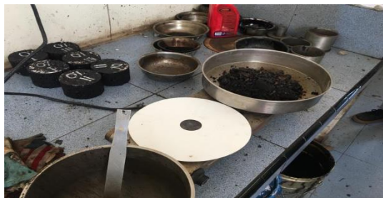
Gambar 4.2 Proses Ekstarsi Agregat
