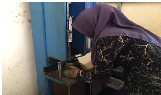
Gambar 4.6 Penumbukan Benda Uji
