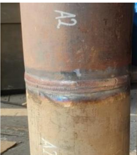
Fig. 3. Finished weld filler ER 309Lmo
