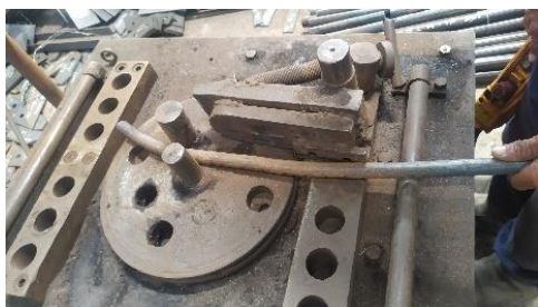
Gambar 4. Proses cold bending dengan mesin rebars bender Krisbow KW1500837
