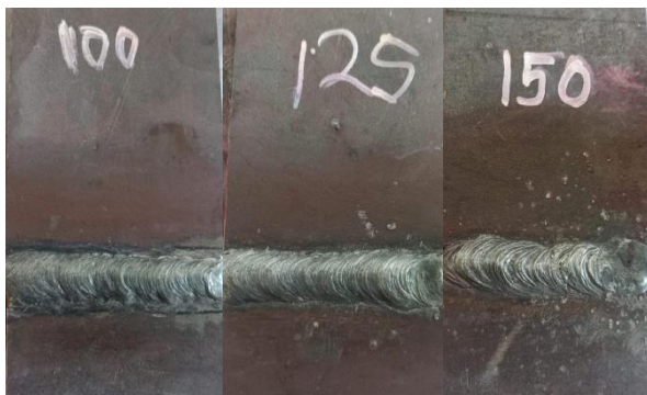
Gambar 6. Hasil pengelasan arus 100 A, 125 A, dan 150 A
