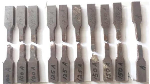
Gambar 10 Hasil Uji Tarik Spesimen Arus 100A, 125 A, dan 150
