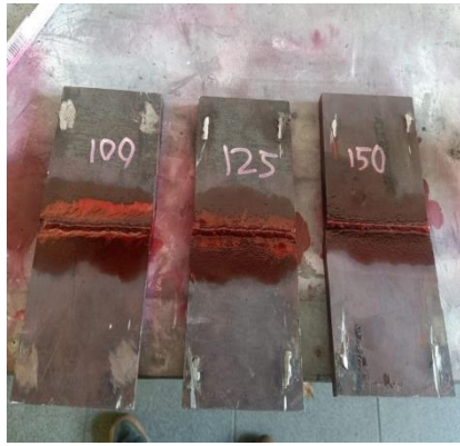
Gambar 4. Proses Pengujian NDT Penetrant Test
