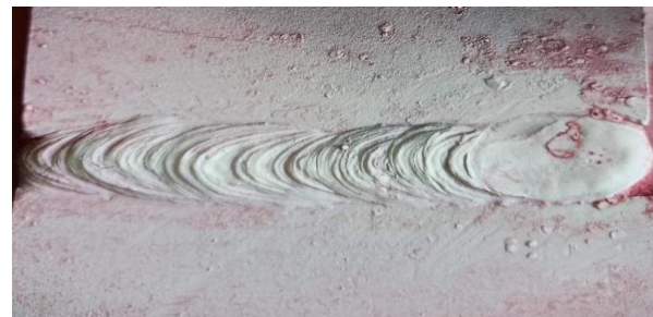
(c) Hasil pengujian NDT Penetrant Test pada arus 150 A
