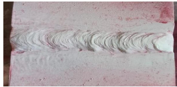
(a) Hasil pengujian NDT Penetrant Test pada arus 100 A
