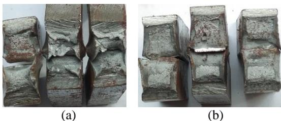
**Gambar 7.** Hasil patahan dengan sudut keruncingan elektroda tungsten (Ewth-2) (a)  $15^{\circ}$  dan (b)  $90^{\circ}$
