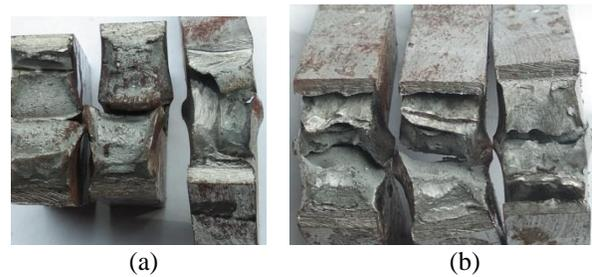
**Gambar 8.** Hasil patahan dengan sudut keruncingan elektroda tungsten (Ewth-2) (a)  $30^{\circ}$  dan (b)  $60^{\circ}$
