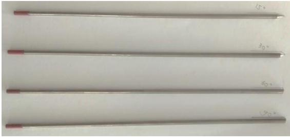
**Gambar 3.** Variasi sudut keruncingan elektroda tungsten (Ewth-2)
