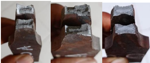
Gambar 6. spesimen patahan setelah uji tarik dengan arus pengelasan 100 A
