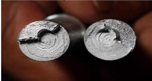
**Gambar 6.** Patahan spesimen uji pada 2500 Rpm
