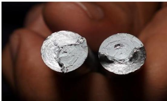
**Gambar 7.** Patahan spesimen uji pada 1500 Rpm
