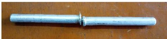
Gambar 3. Benda uji tarik *friction welding* yang tidak center pada penyambungannya
