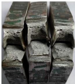
Gambar 9 Hasil perpatahan pengelasan SMAW
