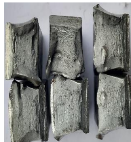
Gambar 10. Hasil perpatahan pengelasan GTAW
