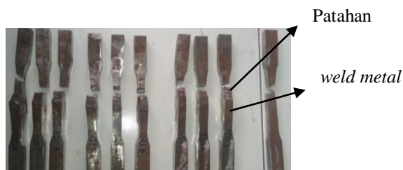
Gambar 6. Hasil uji tarik spesimen arus 100A,125A,dan 150A
