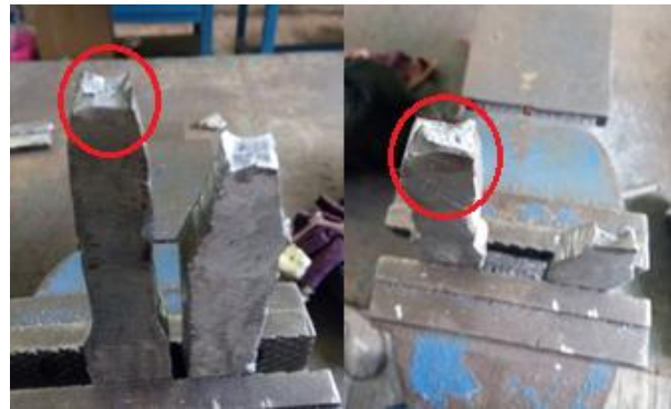
Gambar 6. Penampang las dengan media collant radiator
