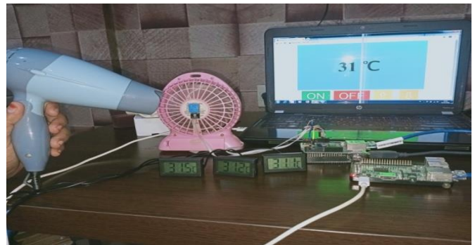
Gambar 11. Perbandingan Modul dan Thermometer Menggunakan Hairdryer
