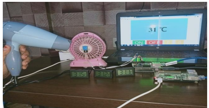
Gambar 11. Perbandingan Modul dan Thermometer Menggunakan Hairdryer
