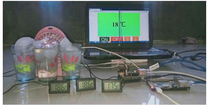
Gambar 10. Perbandingan Modul dan Thermometer Menggunakan Uap Es
