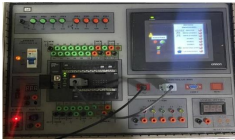
Gbr 15 Modul PLC
